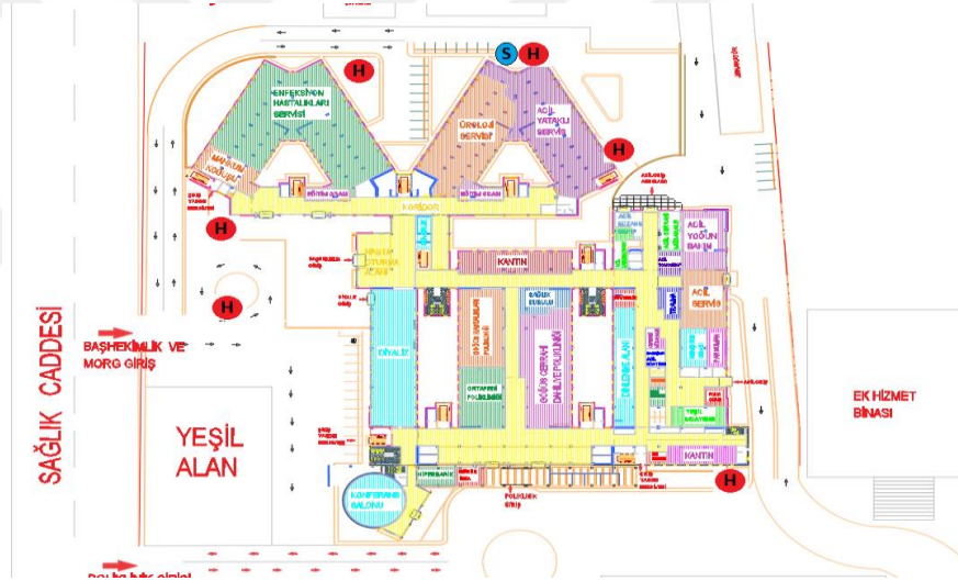
Şekil 2.40. Hastane Çevresinde Bulunan Hidratların ve Su Verme Ağızının Dağılımı
