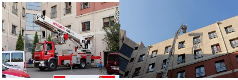
Şekil 3.2. Bina Duvarına Yakın Yanaşan İtfaiye Aracına Örnek
