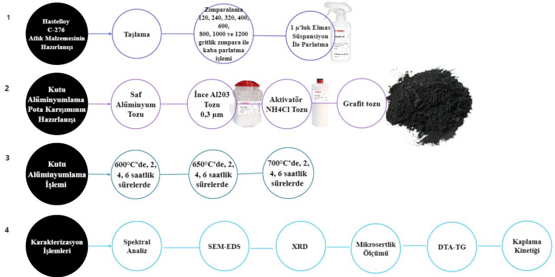
Şekil 4.4. Hastelloy C-276 alaşımı kutu alüminyumlamasını gösteren akım şeması.
