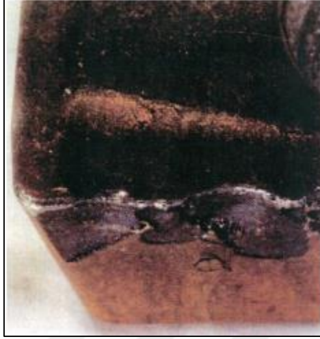
Şekil 2.18. Kesici takımda meydana gelen kırılma [23].
