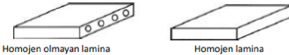
Şekil 6: Homojen Bir Laminaya Benzeyen Fiber ve Matristen Oluşan Homojen Olmayan Bir Lamina (Kaw, 2006)
