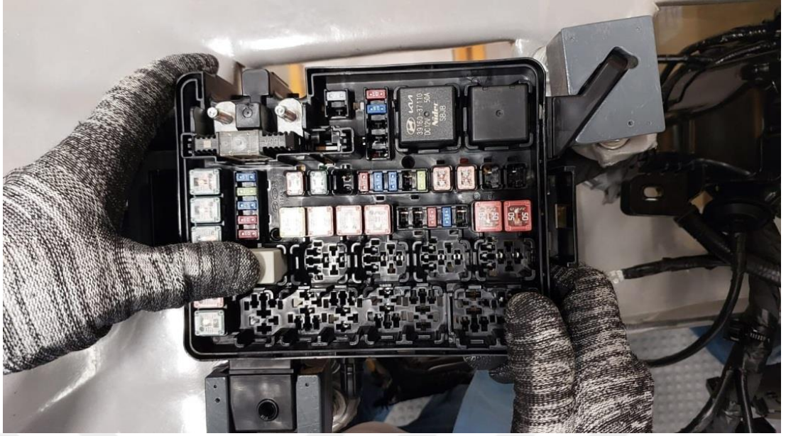
Şekil 2.4. Sigorta yerleştirme metodu.
