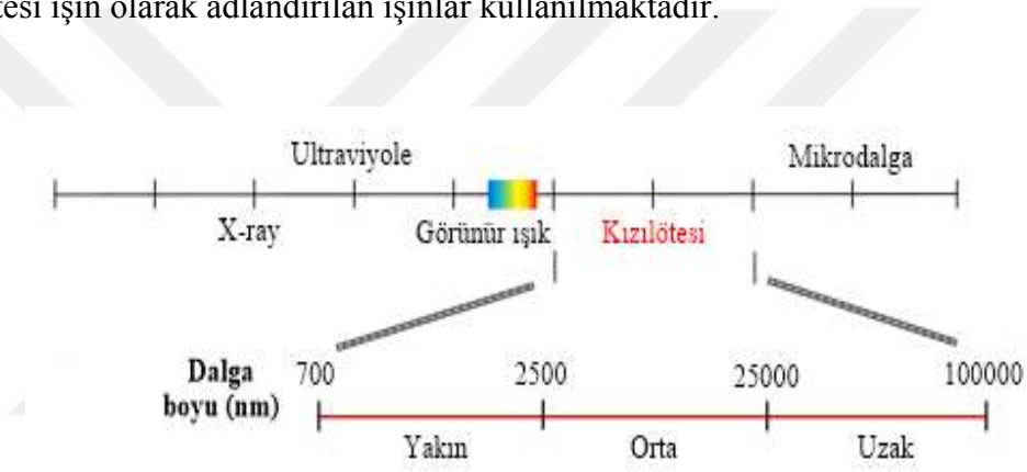
Şekil 3.2. Elektromanyetik spektrum üzerinde kızılötesi ışınların gösterimi
