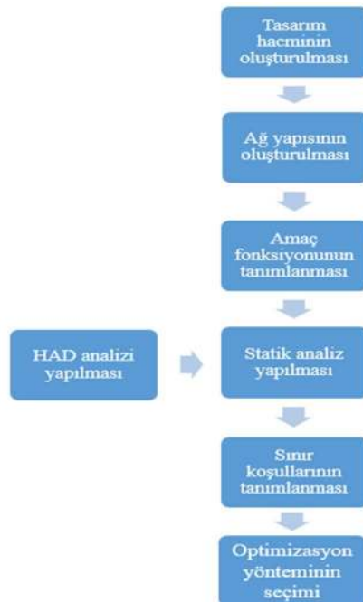
Şekil 3.1. Topoloji Optimizasyonu Akış Şeması
