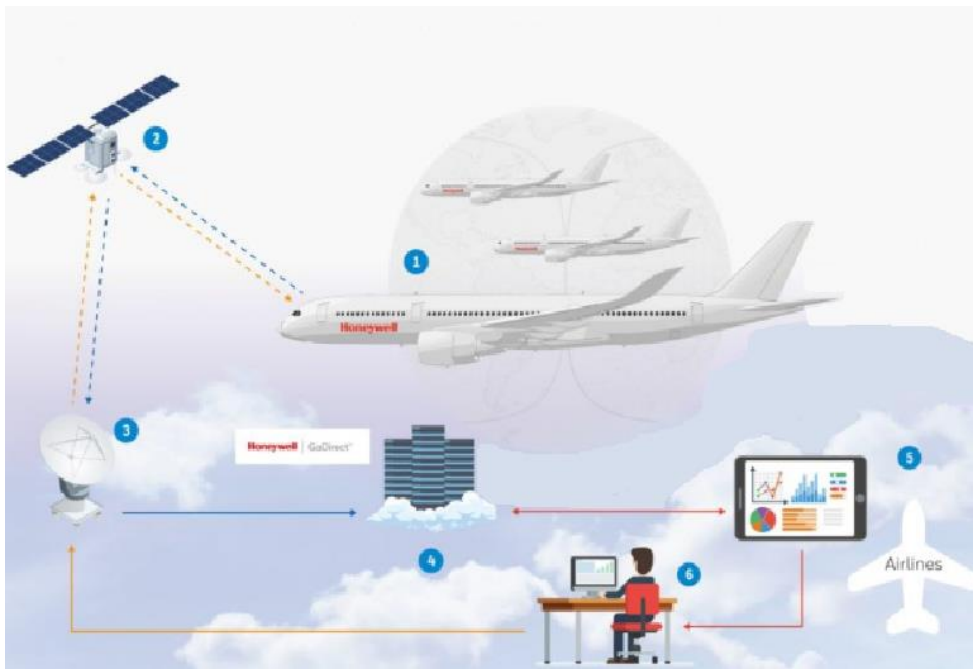
Resim 4.7. Honeywell Aerospace ve ortaklarının gerçek zamanlı kara kutu veri aktarımı çalışmaları
