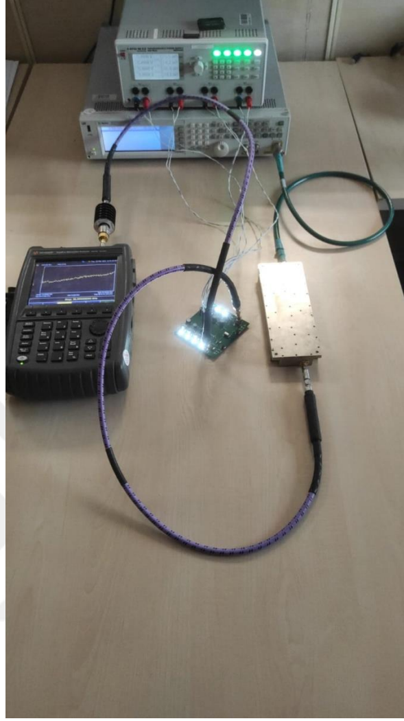
Şekil 46 - RF Güç Ölçüm Test Düzeneği
