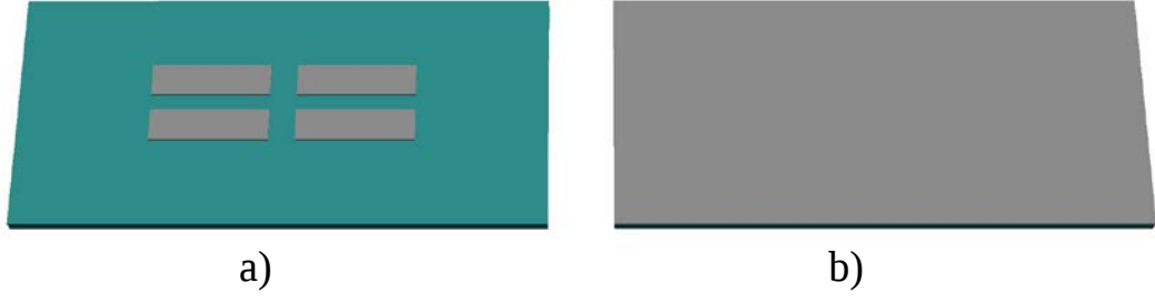
Şekil 2.14. 2x2 elemanlı mikroşerit dizi antenin a) Üstten görünüşü b)Altan görünüşü
