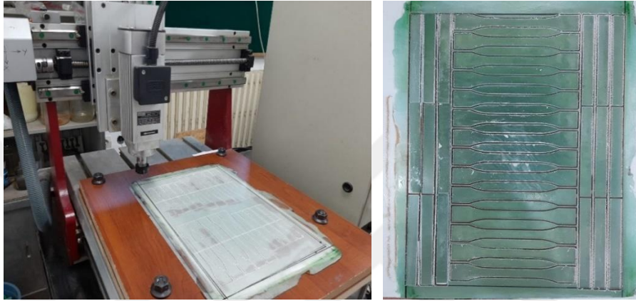
Şekil 70. CNC router ile numune kesme operasyonu
