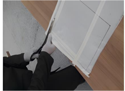
Şekil 61. Cam elyaf dokuma kumaşların kesimi
