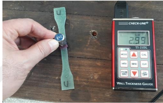
Şekil 83. Check-Line T1-250 L ultrasonik kalınlık ölçüm cihazı
