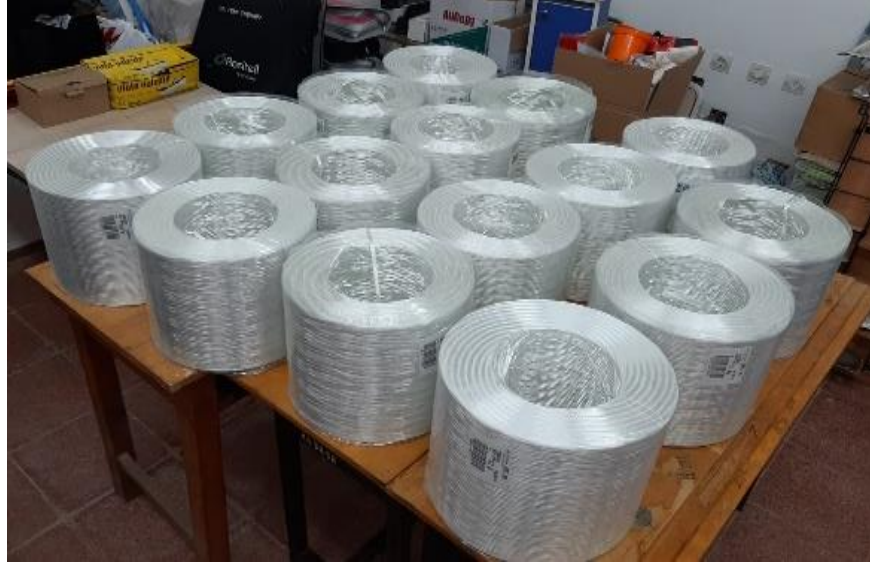
Şekil 52. Tek uçlu cam elyaf fitil ürünler
