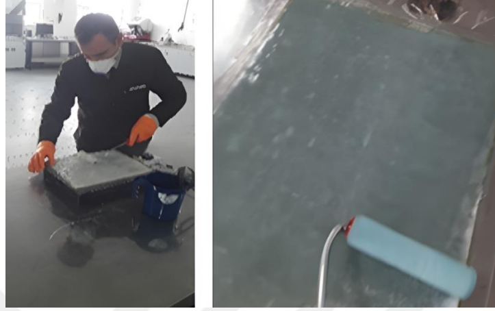
Şekil 64. Kalıba yerleştirilen dokuma kumaşlara reçine uygulaması
