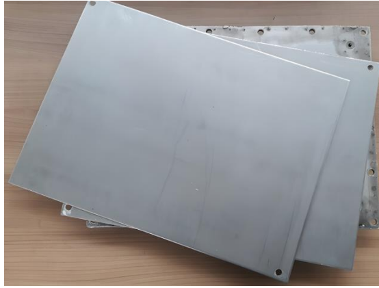
Şekil 67. Kalıp arasına ilave edilen paslanmaz sac levhalar
