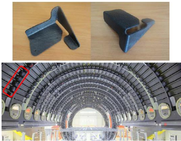
Şekil 22. Air Bus A350XWB yolcu uçağı gövde klipleri (Özel ve Temiz, 2018)
