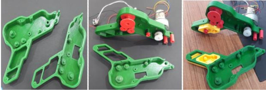
Şekil 47. 3D yazıcı da üretilen kompozit yama cihazı parçaları
