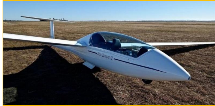
Şekil 8. Cam elyaf takviyeli kompozit kullanılan bir planör (Keskin vd., 2019).
