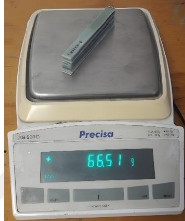
Şekil 73. On adet eğme numunesi ağırlığının ölçümü
