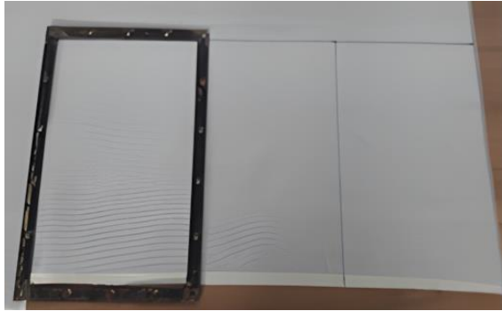
Şekil 61. Cam elyaf dokuma kumaşların kesimi
