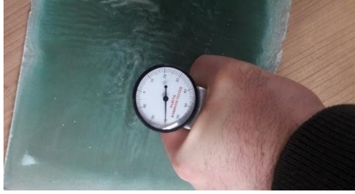
Şekil 93. Barcol cihazı ile sertlik ölçümü
