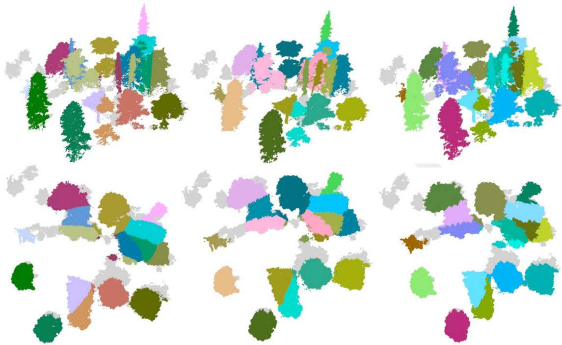
Şekil 70. Silva2016 algoritması ile 0,10 (sol), 0,50 (orta) ve 1,00 (sağ) metre çözünürlüklerle elde edilen segmentasyona ait yandan ve üstten görünüm
