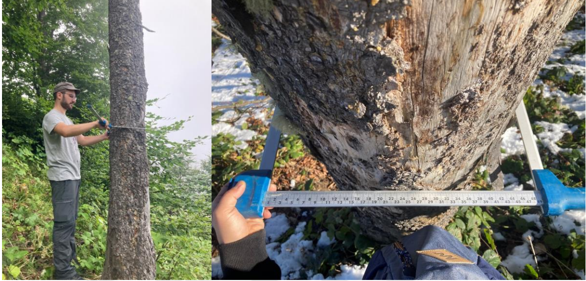
Şekil 73. Ağaç gövde çapının çap ölçer aletiyle ölçülmesi
