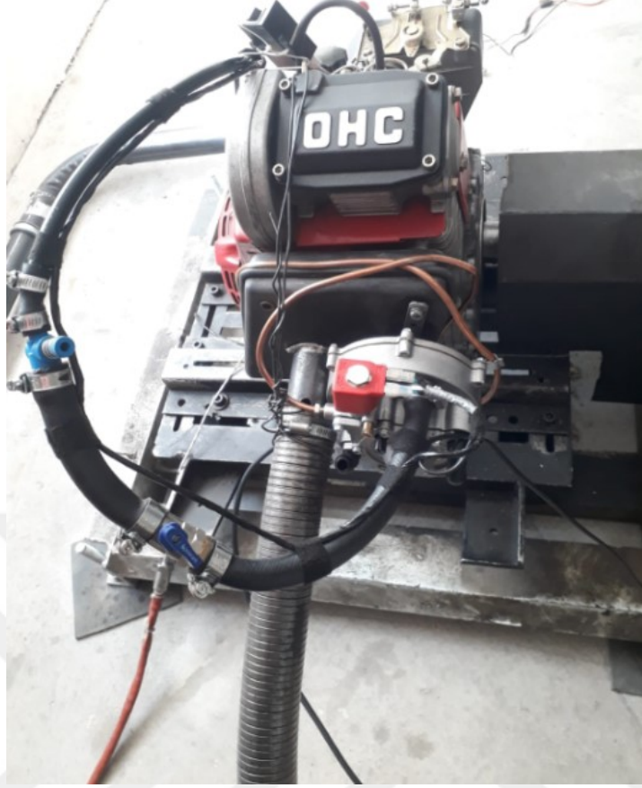
Resim 3.3 Benzin motoruna LPG uygulaması.
