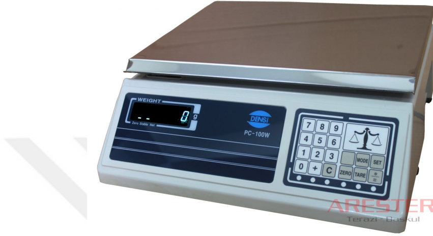
Resim 3.6 Deneylerde kullanılan hassas terazi.
