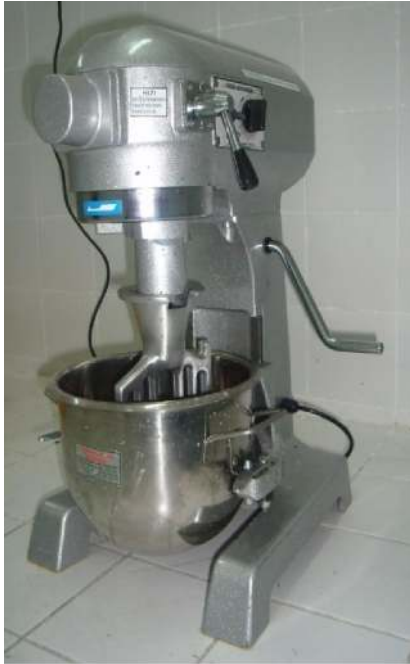
Şekil 2.3. Özel tasarım çimento harç karıştırıcısı
