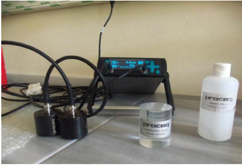
Şekil 2.5 Ultrasonik test cihazı
