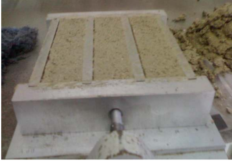
Şekil 2.4 Sıkıştırıldıktan sonra yüzeyi düzeltilmiş harç örneği
