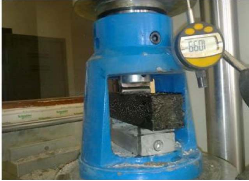
Şekil 2.6 Eğilme deneyinde sehim ölçümü
