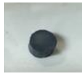
Şekil 4.11 Au kaplı Nb numunenin alüminyumlama sonrası fotoğrafı (Kişisel arşiv, 2015)
