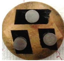
Şekil 4.3 Sputtering yöntemiyle 6 dakika altın kaplanmış Nb numunelerin fotoğrafı (Kişisel arşiv, 2014)
