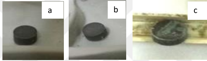
Şekil 4.25 Alüminyumlanmış Nb numunelerin oksidasyon sonrası görüntüleri a) 500°C’de oksitlenen b) 800°C’de oksitlenen c) 1000° C’de oksitlenen (Kişisel arşiv, 2016)
