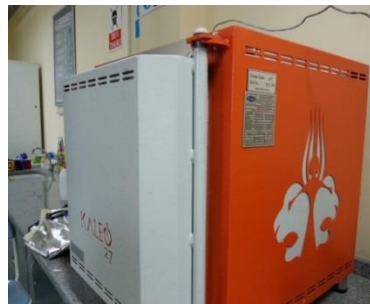
Şekil 3.3 Sementasyon ve oksidasyon deneylerinin yapıldığı Kaleo marka kutu fırın (Kişisel arşiv, 2019)
