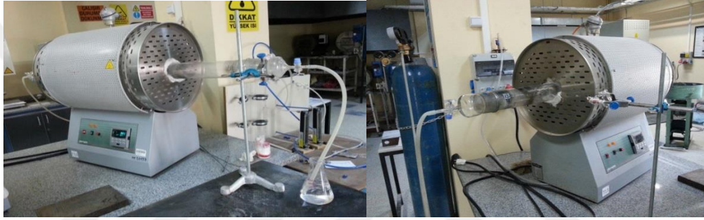
Şekil 3.6 Isıl işlemlerin gerçekleştirildiği Protherm markalı tüp fırın ve deney sistemi (Kişisel arşiv, 2016)
