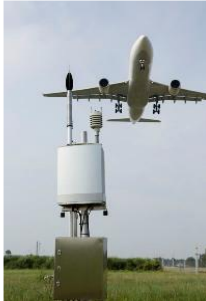
Şekil 2.7. Havaalanı gürültü ölçüm ekipmanı (Pro-Plan, 2023)
