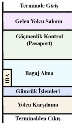
Şekil 5.54. Dalaman Havalimanı Dış Hatlar Terminali gelen yolcu fonksiyonu düzeni ile yeni önerilen genel fonksiyon düzeni karşılaştırılması
