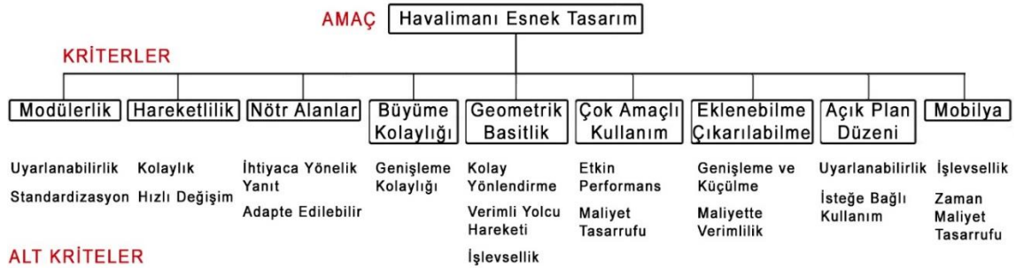
Şekil 5.55. Havalimanı Terminalleri Esnek Tasarımı için AHP'nin Hiyerarşik Yapısı
