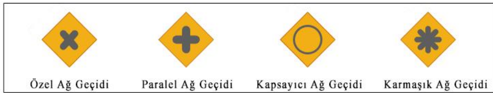
Şekil 5.21 Geçit (akış elemanları) türleri
