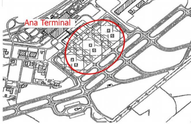
Şekil 2.5. Montreal Mirabel Havalimanı Taşıyıcı Tipi Terminal (IATA verilerinden düzenlenmiştir) (SGHM, 2009)
