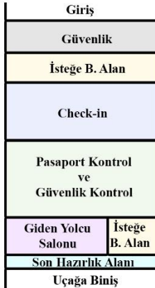
Şekil 5.53. Dalaman Havalimanı Dış Hatlar Terminali giden yolcu fonksiyonu düzeni ile yeni önerilen genel fonksiyon düzeni karşılaştırılması
