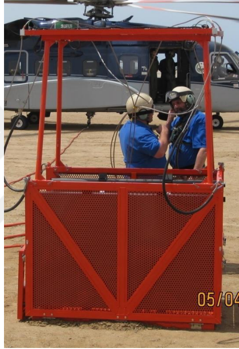
Şekil 2. Personel Taşıma Cihazı Sistemi Temsili tasarım
