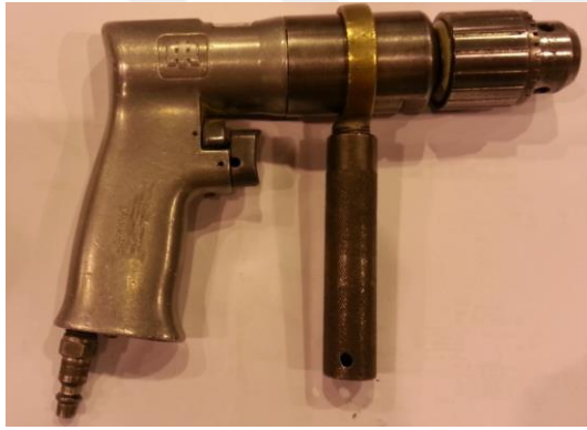
Resim 4.3. Faz-1 çalışmasında kullanılan havalı manuel delik delme ekipmanı
