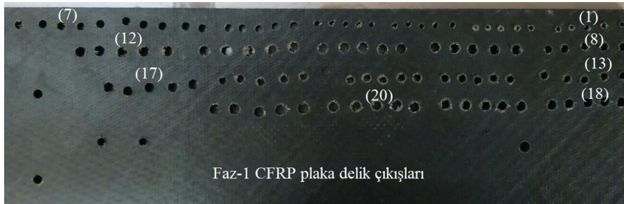
Resim 4.8. CFRP plaka delik çıkışlarında oluşan çapaklanma gösterimi
