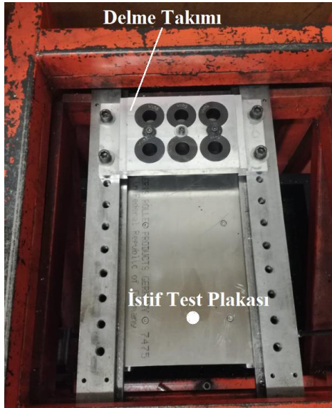
Şekil 4.13. Delme takımı ve istif test plakasının test platformu üzerine yerleşimi
