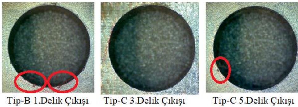
Şekil 5.36. Delik çıkışları delaminasyon sonuçları
