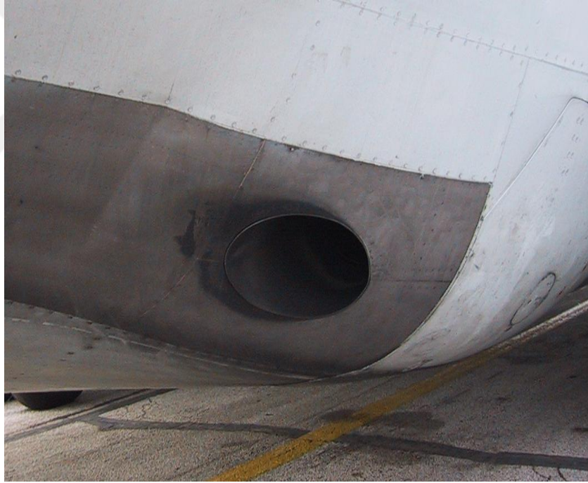
Şekil 1.17 : Yardımcı Güç Ünitesi (APU-Auxiliary Power Unit) egzozunun yanı sıra korozyona karşı belirli bir korumaya ve düzenli bakıma ihtiyaç duyan motor egzoz bölmeleri [9].
