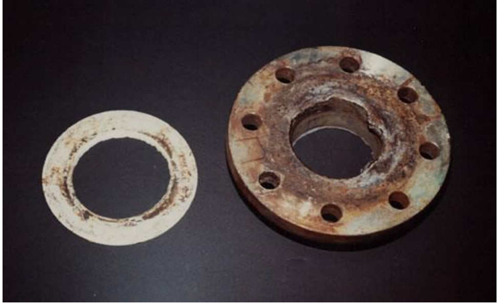
Şekil 1.7 : Metal yüzeyindeki aralık korozyonu örneği [8].
