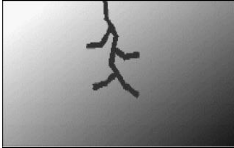
Şekil 1.12 : Gerilmeli korozyon çatlağı [8].
