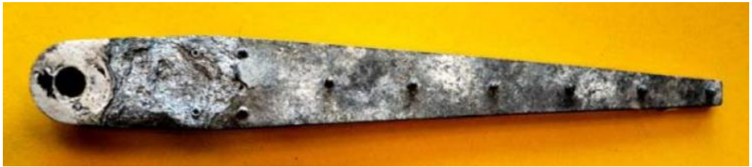
Görsel 3.4. Karbon fiber kompozit parçaları gövdeye monte etmek için kullanılan alüminyum alaşımlı bağlantı ataşmanı ( http-2 )
