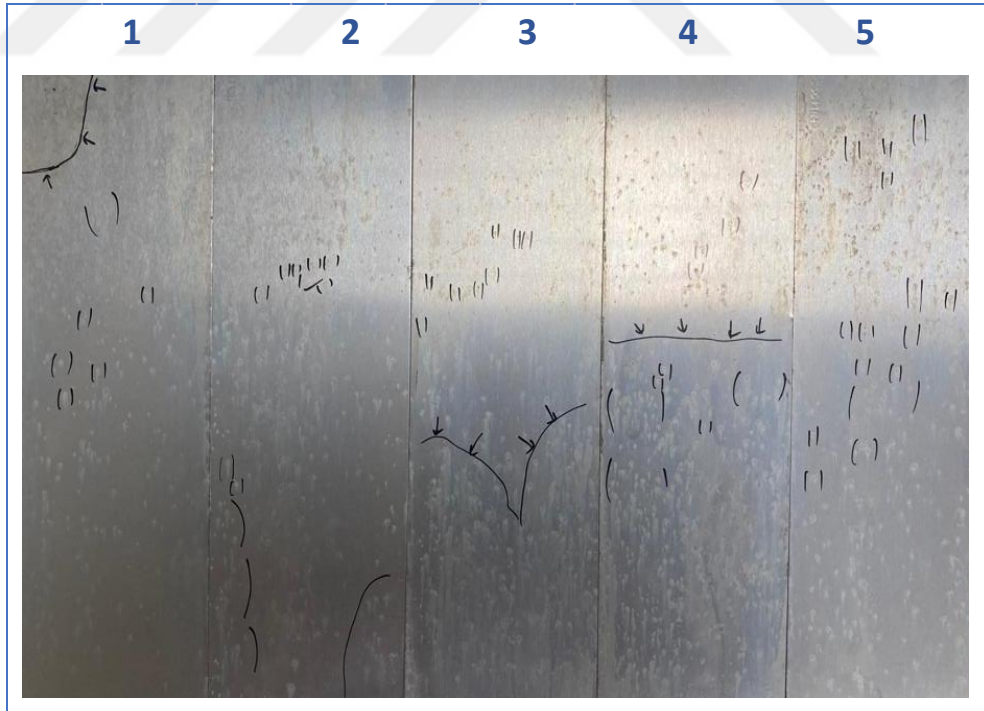
Görsel 6.5. Tuz sisi testi sonrası 2024-T3-Cr(III)-35 numunesi (çizgi, daha yüksek yoğunluklu çukur alanlarını temsil ederken, işaretli alanlar çukur sayımını temsil eder)
