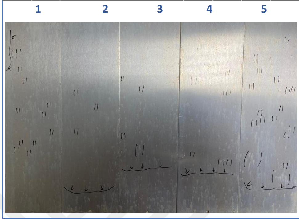
Görsel 6.4. Tuz sisi testi sonrası 2024-T3-Cr(III)-25 numunesi (çizgi, daha yüksek yoğunluklu çukur alanlarını temsil ederken, işaretli alanlar çukur sayımını temsil eder)
