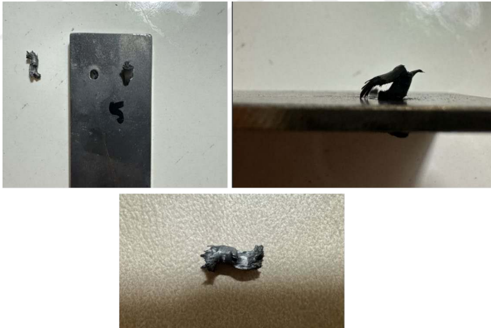
Şekil 4.9. CF/PEKK Perçinlerde Deney Sonrası Hasar
