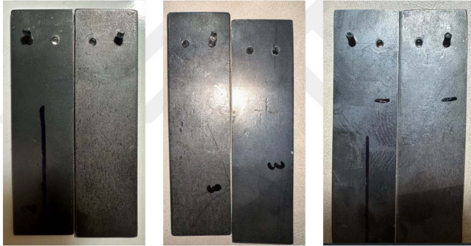
Şekil 4.7. Çekme Testi Sonrası CF/PEKK Numuneleri
