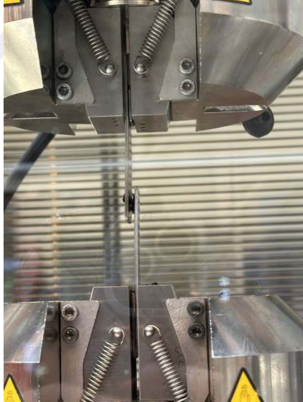
Şekil 2.13. Deney Sonrası CF/PEKK Perçinde Gözle Görünür Deformasyon
