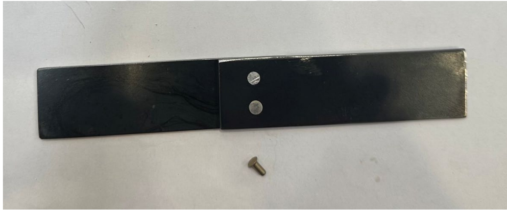
Şekil 2.4. Alüminyum Perçin Montajı Yapılmış Test Numunesi
