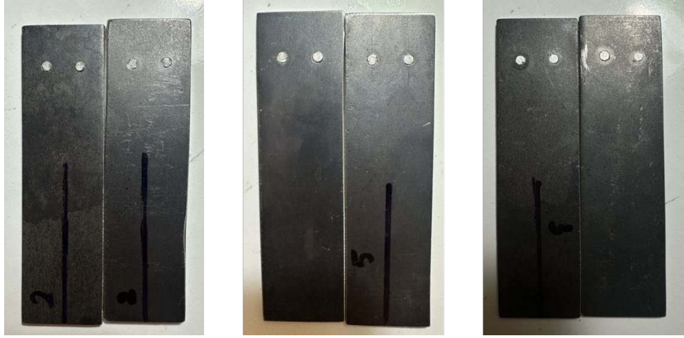
Şekil 4.3. Kopmaya uğrayan Alüminyum Perçinli Numuneler
