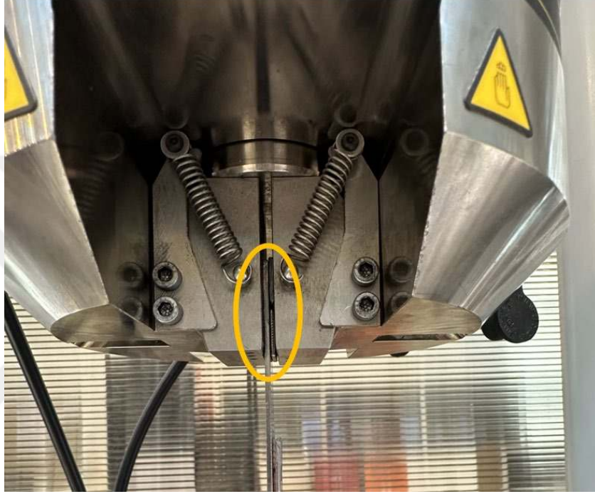
Şekil 2.14. Deney Öncesi Aksel Yükleme Önleyici Metal Plakalar
