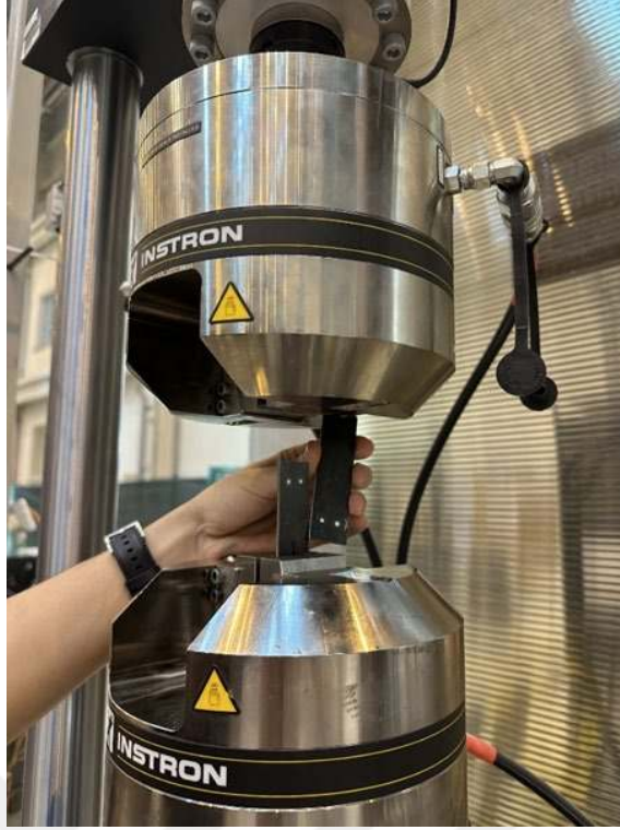
Şekil 2.9. Kopması Gerçekleşen Alüminyum Perçin Numunesi
