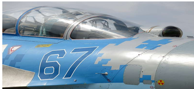
Şekil 32: SU-27 Kızılötesi Arama ve İzleme Sistemi (SU-27, 2020)
