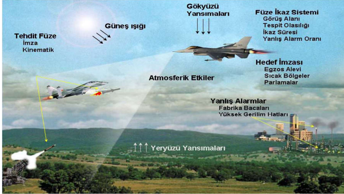
Şekil 26: Genel Füze İkaz Sistemi Görüntüsü (Salman, 2009)
