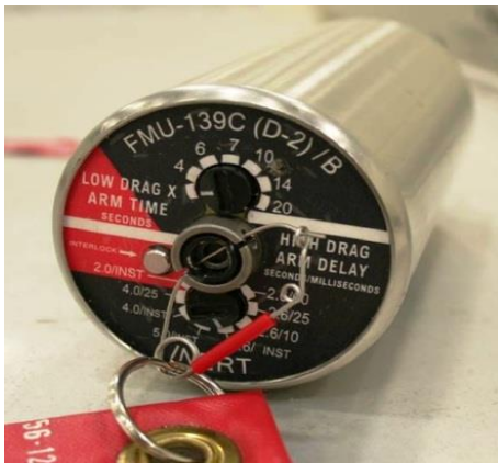
Şekil 5.17 : FMU-139C elektronik ve FMU-143 serisi elektrikli fünyeler (CNATT, 2006).
