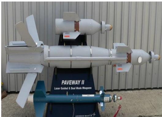
(a) Paveway II isimli mühimmata ait yavaşlatma elemanları (Gielle, t.y)
