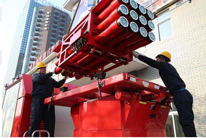
Şekil 2.9 : İtfaiye aracı üzerinde bulunan kaideye yüklenmiş yangın söndürü roketleri (Lei, 2017).
