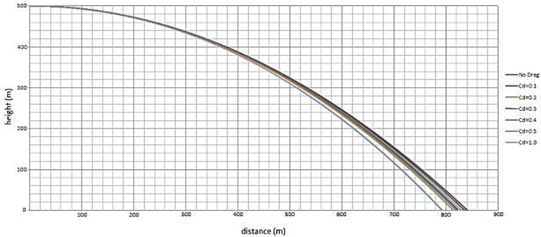
Şekil 7.5 : Farklı yükseklik ve atım hızlarında AYSM'nin takip ettiği yörünge ( V_{xo}=83.3 m/s, yükseklik=300 m).
