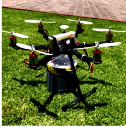
Şekil 2.6 : Cervantes ve diğerleri tarafından tasarlanan itfaiye dronu olarak önerilen kavramsal tasarım prototipi (Radu, 2019).
