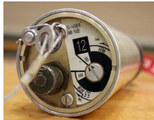
Şekil 5.17 : FMU-139C elektronik ve FMU-143 serisi elektrikli fünyeler (CNATT, 2006).
