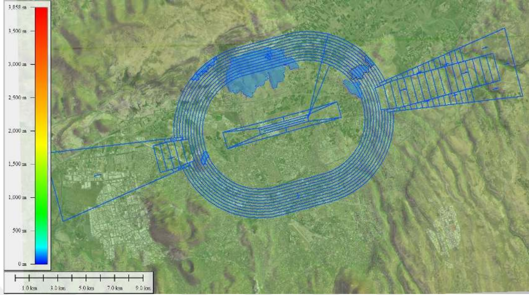
Şekil 5.2. Kayseri Havalimanı mania planı (SHGM)
