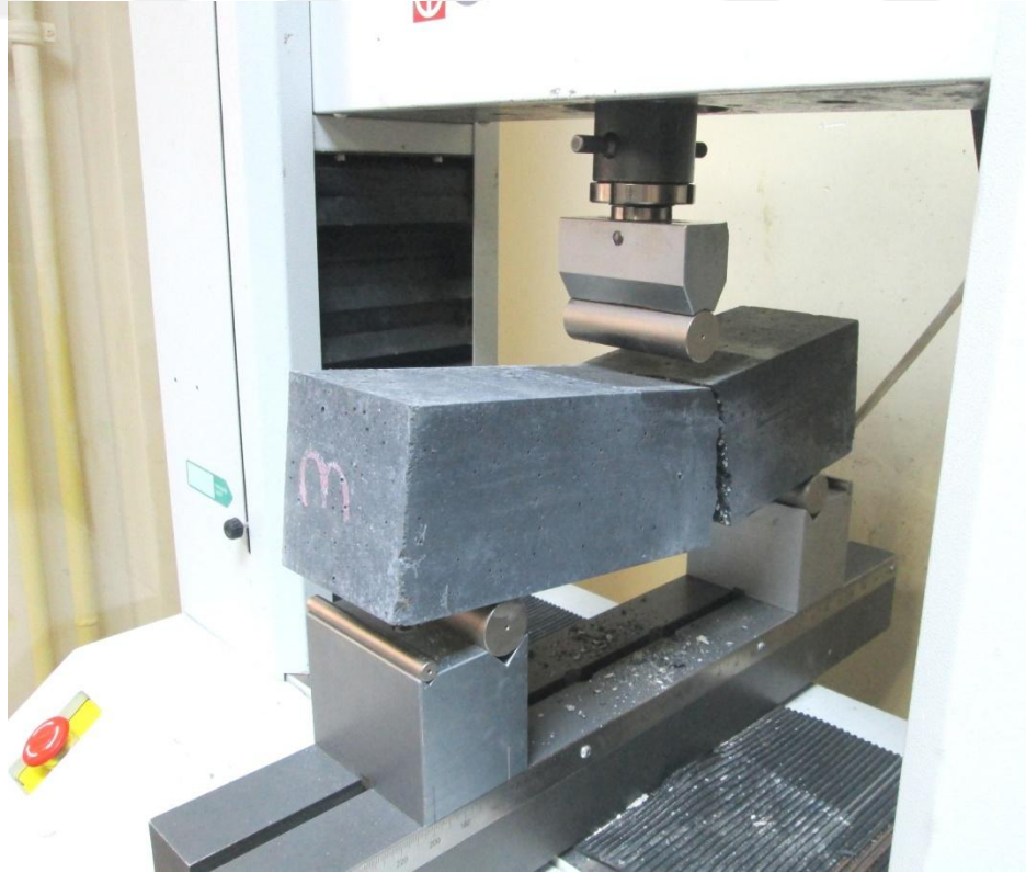
Şekil A.4. Eğme deney sonrası numunede meydana gelen kırılma.
