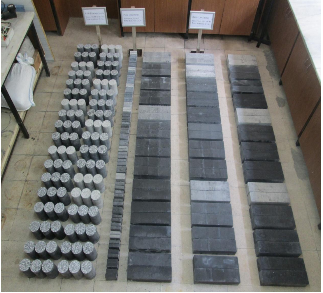
Şekil 3.12. Numunelerin oda sıcaklığında kurutulması.
