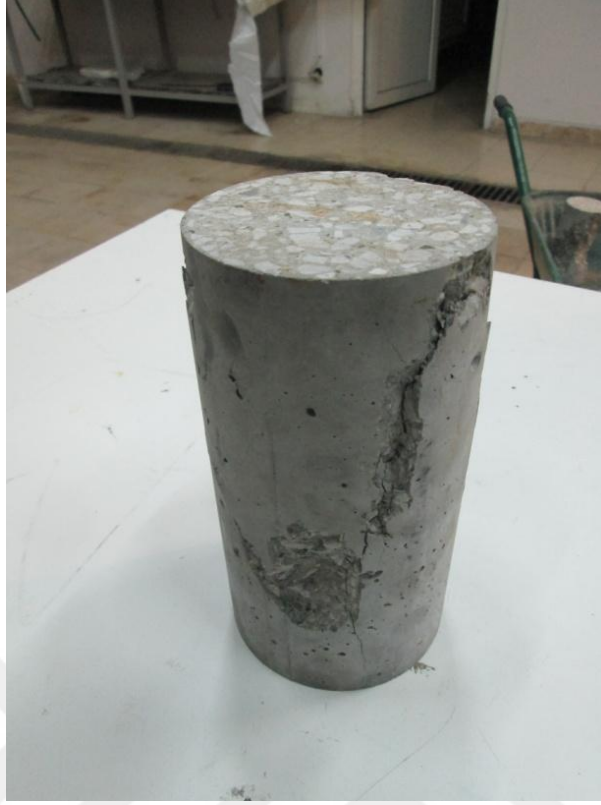
Şekil A.3. Basınç numunelerin kırılma şekli.
