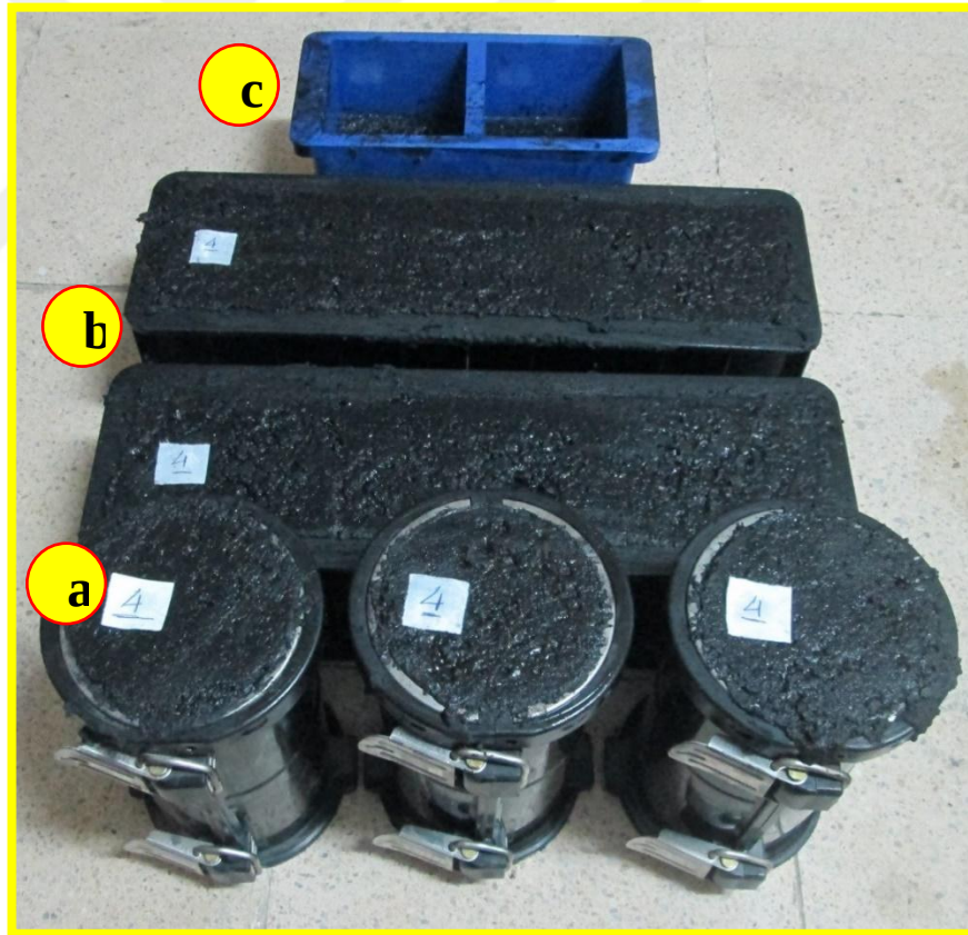
Şekil 3.9. Kalıplanmış numune örnekleri; a) basınç ve ED, b) eğilme deneyi ve c) çarpma deney numuneleri.
