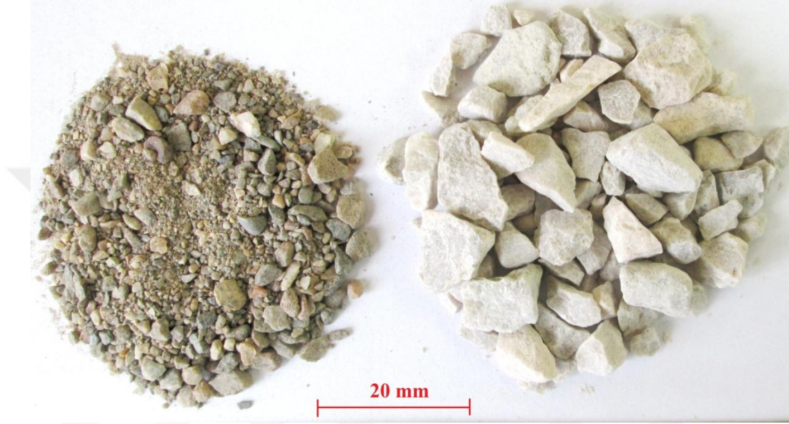
Şekil 3.3. 0-4.75 mm (sol) ve 4.75 -22 mm (sağ) Agrega tipi.
