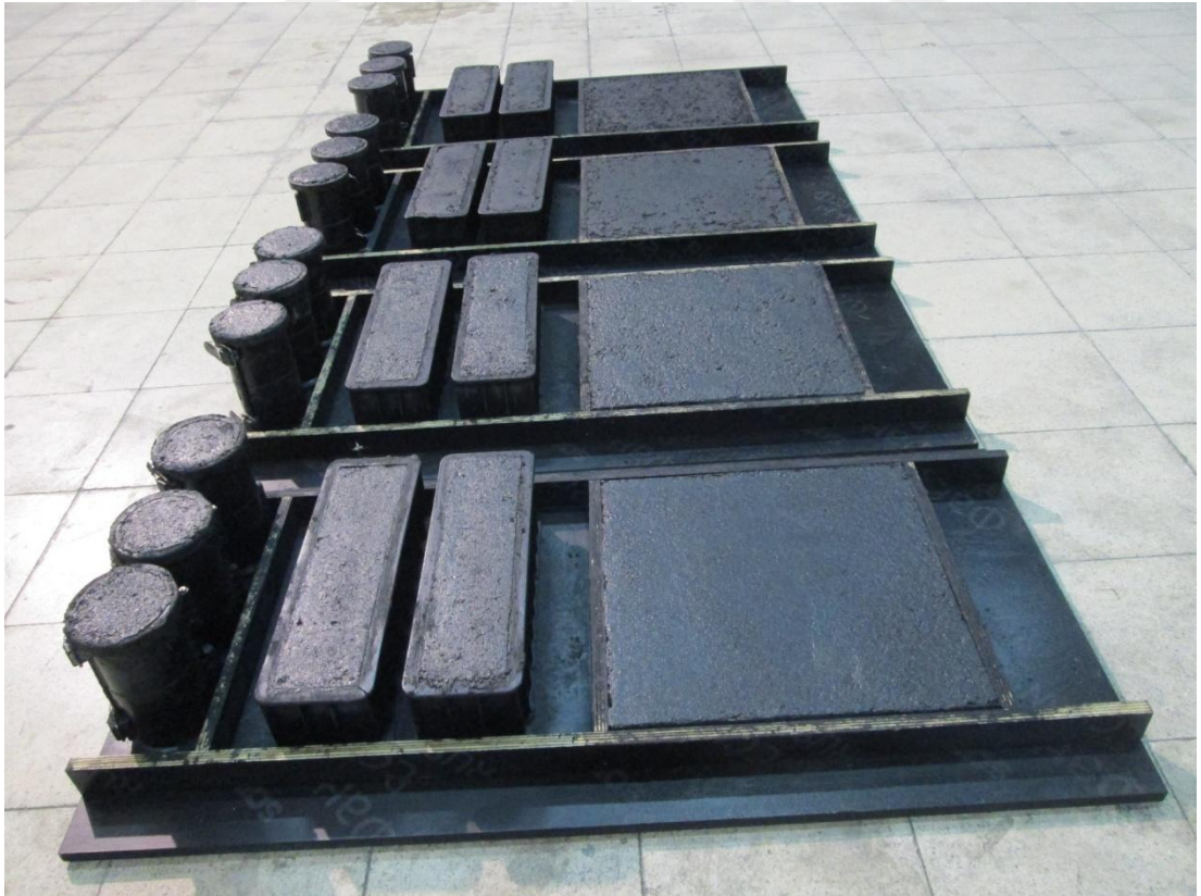
Şekil D.3. ATE içeren numune gruplarının kalıplanması.
