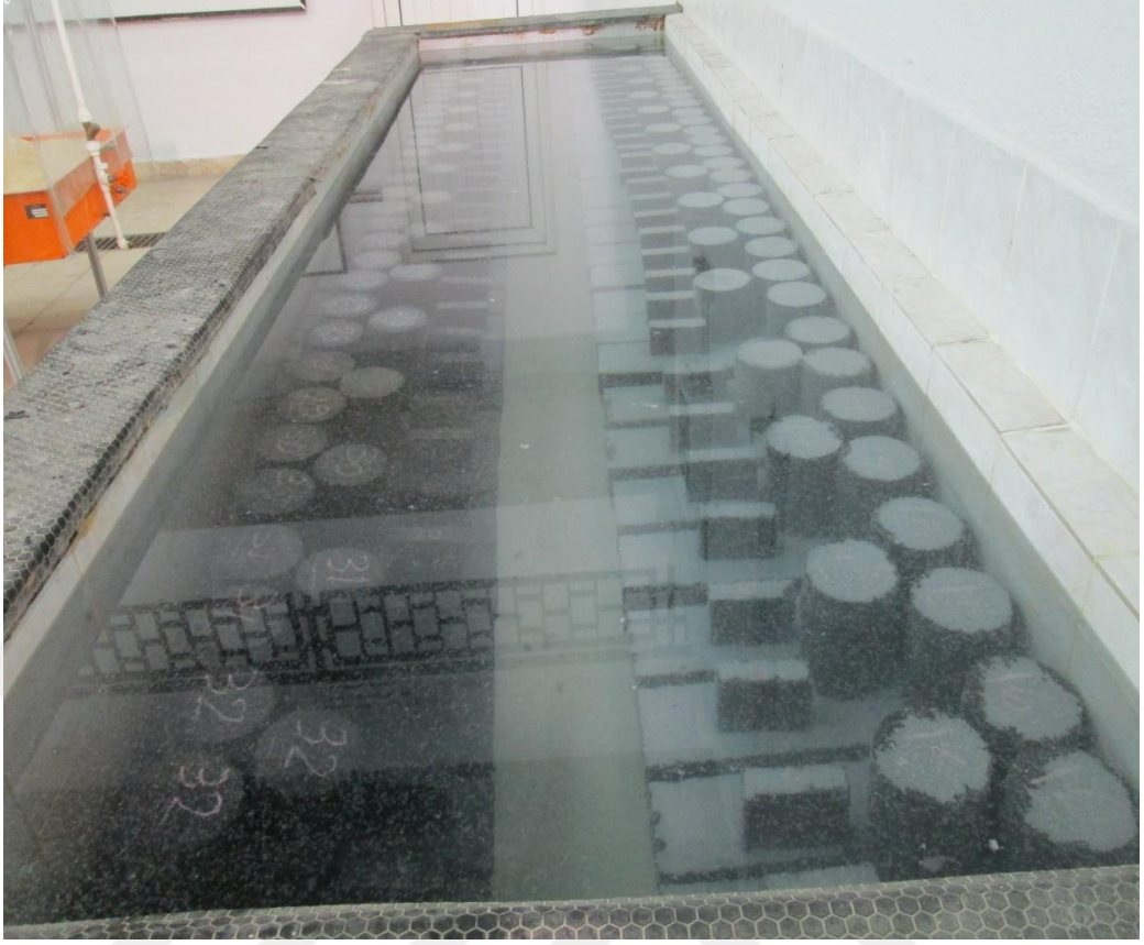
Şekil 3.10. Numunelerin kür havuzunda yerleştirilmesi.
