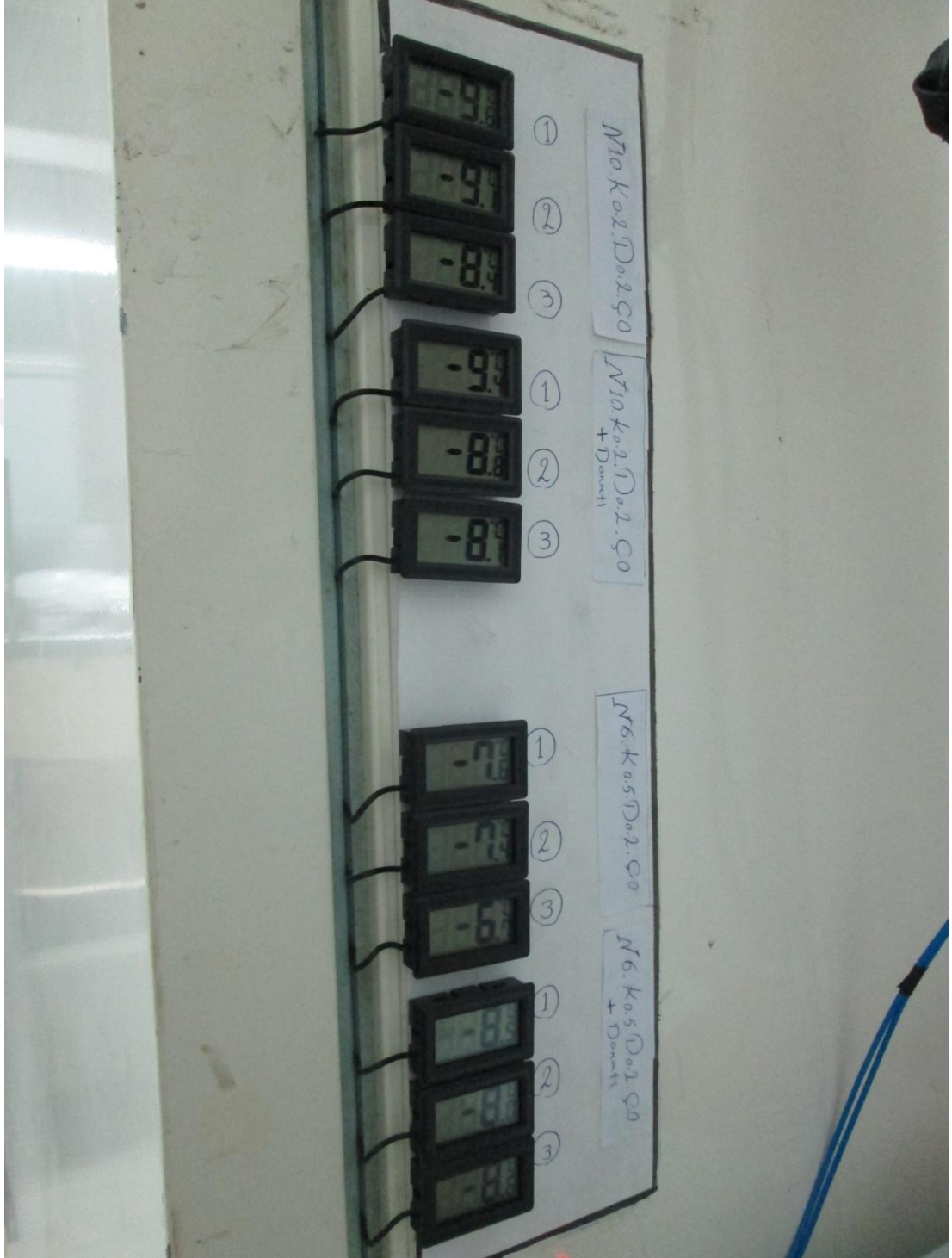
Şekil D.1. soğutucunun içersindeki plaka numunenin sıcak ölçülmesi için termometreler.
