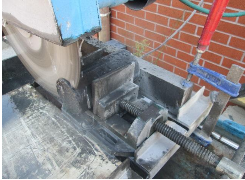
Şekil 3.11. Silindir numunelerin pürüzlü taraflarının kesilmesi.
