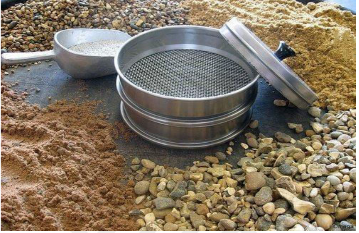
Resim 2. 4. Elek analizi deneyi görünümü (URL-7, 2020)
