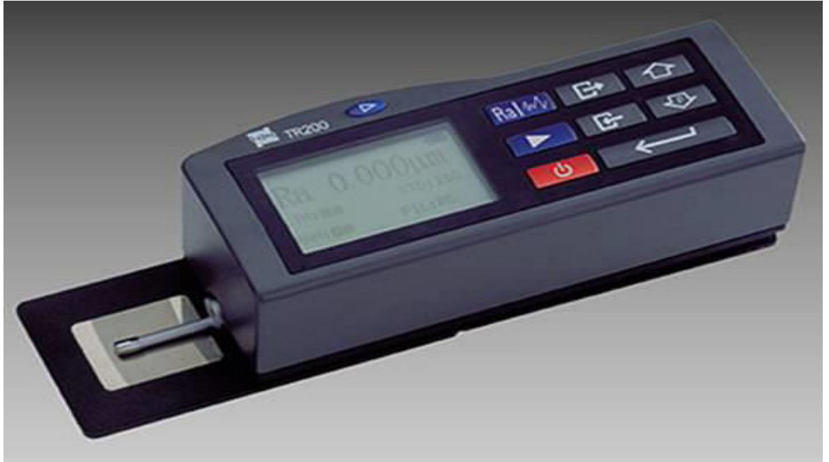
Resim 2. 11. Pürüzlülük ölçüm cihazı (URL-16, 2025)
