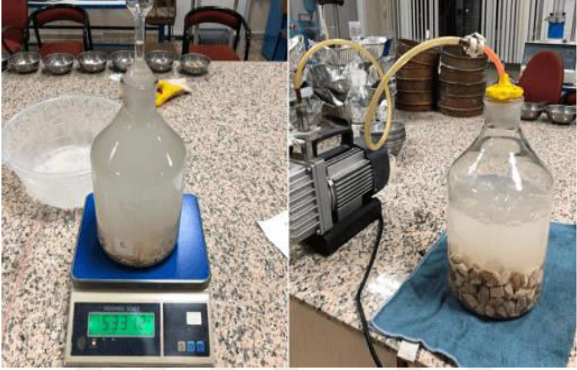
Resim 2. 9. Özgül ağırlık deneyi (URL-13, 2025)
