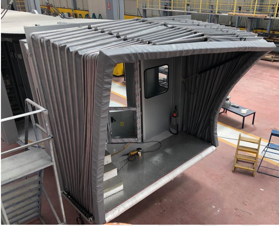
Resim 5.1. Tasarlanan uçak temas körüğünün imalatı
