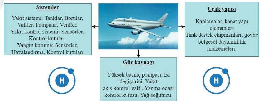
Şekil 4.8. LH 2 uçaklarında yapılması gereken minimum değişiklikler [114]
