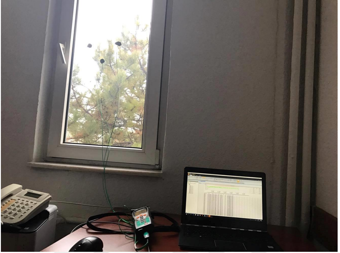
Görsel 5.10. Terminal binası pencereleri U değeri ölçümü
