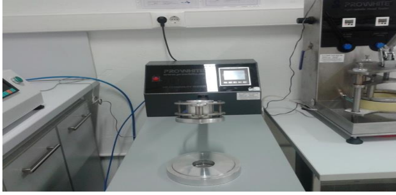
Şekil 5.2: PROWHITE hava geçirgenliği ölçüm cihazı.
