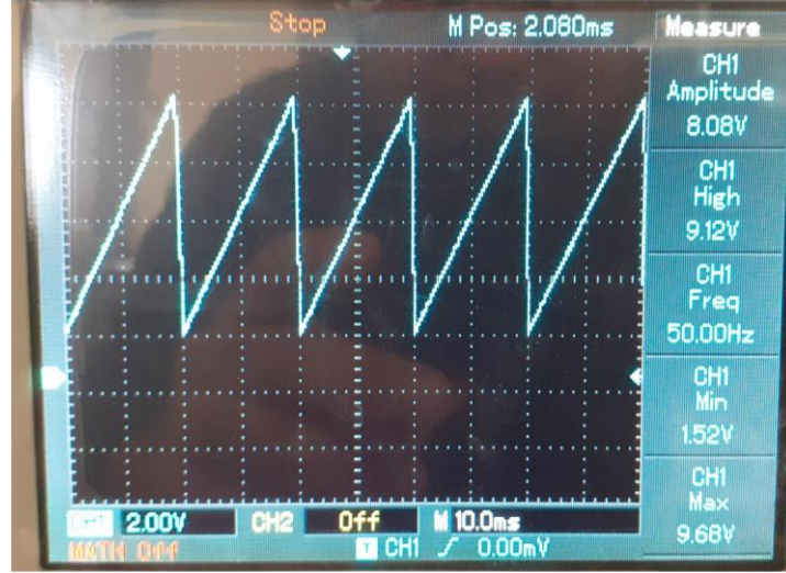
Şekil 4.42 VKO girişine uygulanan testere dişi sinyal
