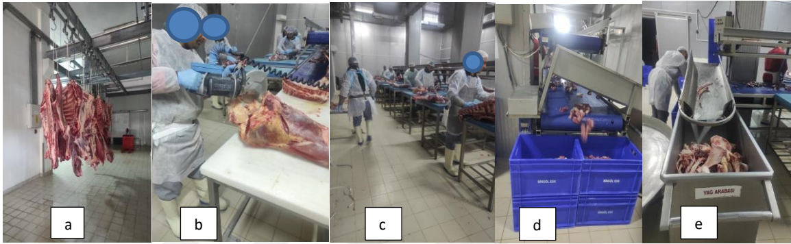
Şekil 1.11. Parçalama bölümünde etin kemikten ayrılması, parçalanması ve kasalara alınması; a)Depodan gelen karkas b)kemikli etin testere ile kesilmesi c) konveyörden tezgahlara alınması d)et parçalarının alt banttan kasaya alınması e) kemik kısımların üst banttan kemik arabasına alınması
