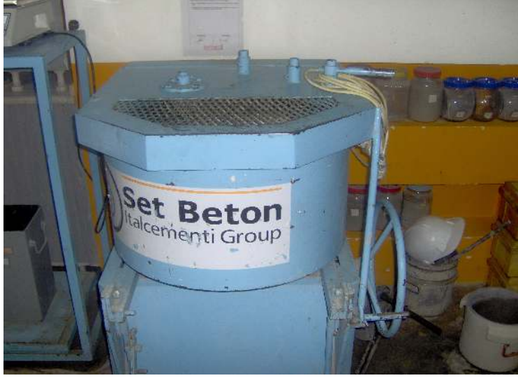
Resim 3.1. 75 dm 3 hacimli betoniyer
