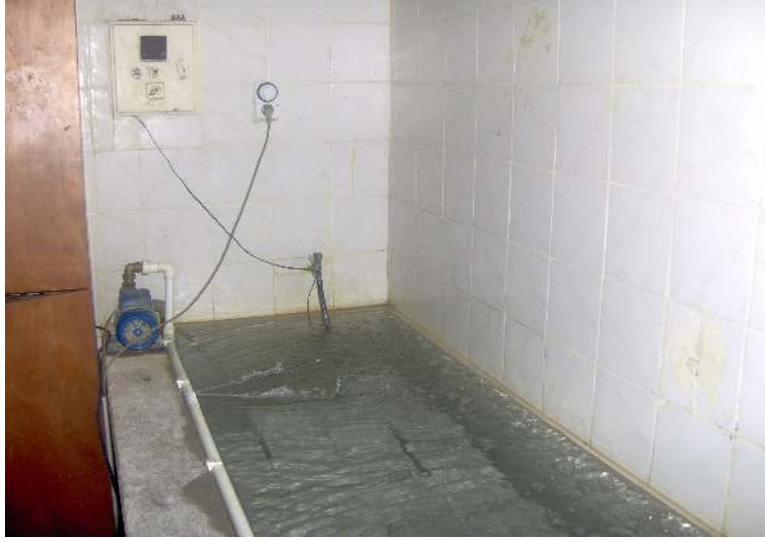
Resim 3.3. 20 \pm 2^\circ\text{C} sıcaklıktaki kür havuzu
