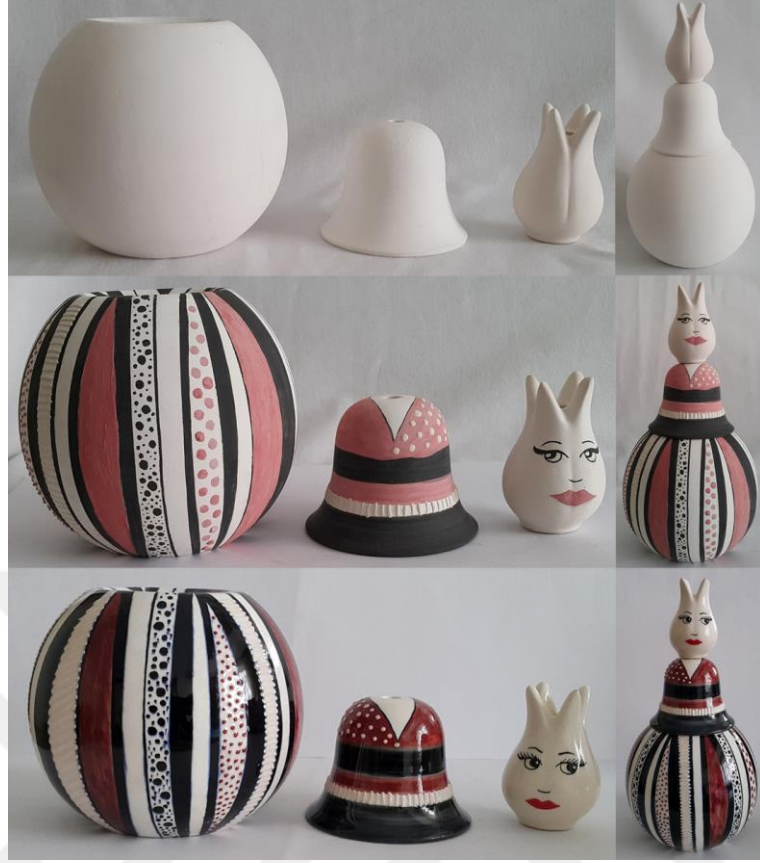
Görsel 3.7. “Sarařan Serisi”, Bisküvi, dekorlu ve sırlı ürünlerin yapım aşamaları (Müge Arın fotoğraf arřivi, 2020)
