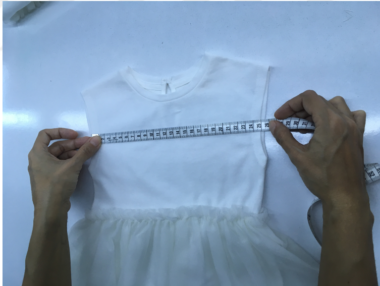
Resim 18. Tüm işlemleri tamamlanmış numunenin ölçülerinin kontrol edilmesi
