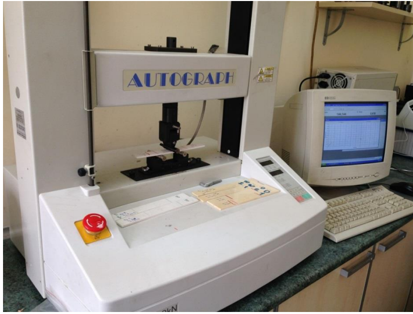
Şekil 6.3 : 3 nokta eğme deneyinin görünümü.
