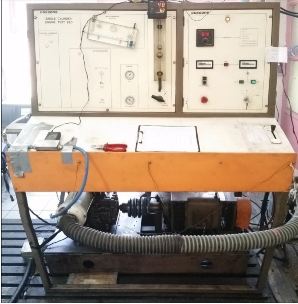
Resim 5.2. Cussons P8160 marka tek silindirli motor test düzeneği
