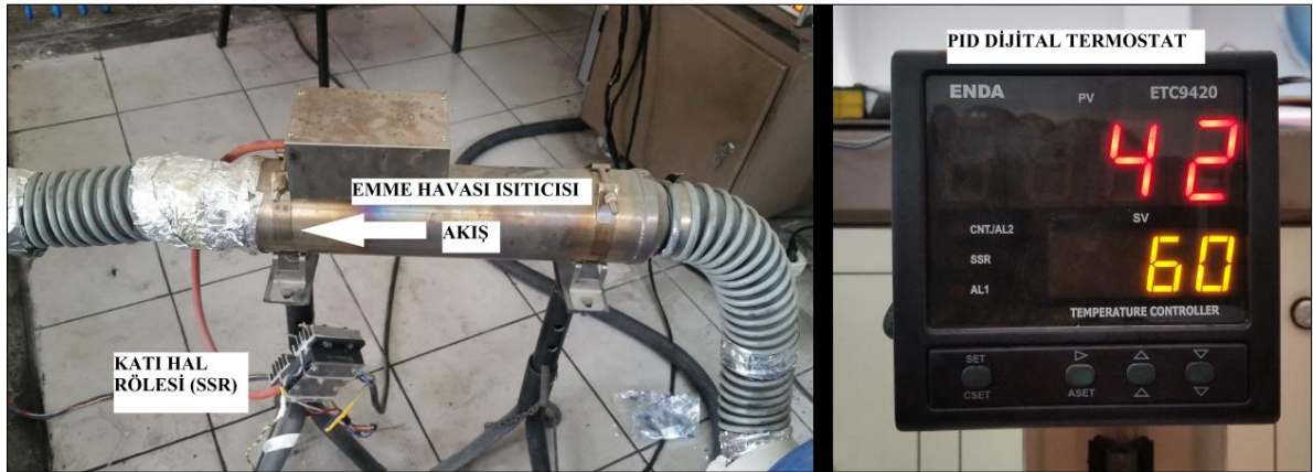
Resim 5.10. Emme havası ısıtıcısı, katı hal rölesi, PID dijital termostat
