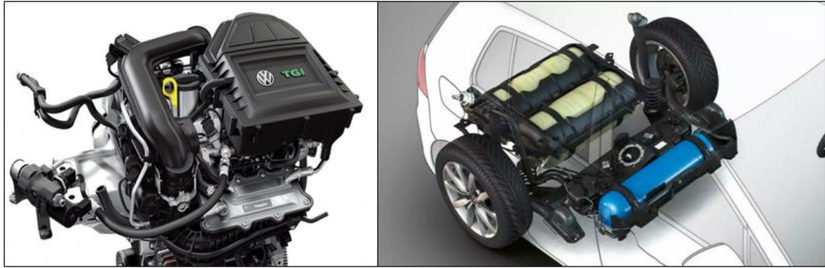
Resim 1.1. Volkswagen firmasının CNG yakıtı ile çalışan turbo gaz enjeksiyonlu (TGI) motoru ve CNG tüplerinin araç üzerindeki yeri [12]
