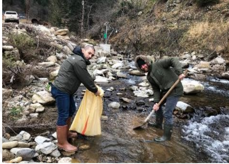
Şekil 16. Dere malzemesinden numune alma işlemi
