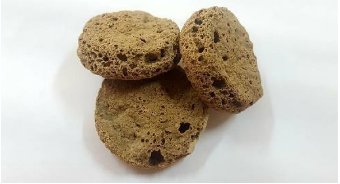
Şekil 4.26 Mikrodalga yöntemiyle elde edilen ağırlıkça %23 üre katkılı pelet
