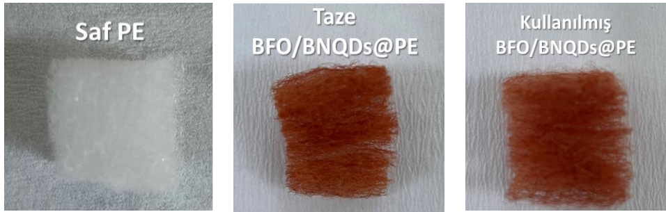
Şekil 5.83. Saf filtre ve BFO/BNQDs kaplı filtrelerin görünümü
