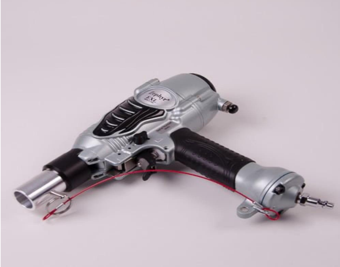
Şekil 10: Delici Olmayan Sabit Sürgülü Bayıltma Tabancası 532
