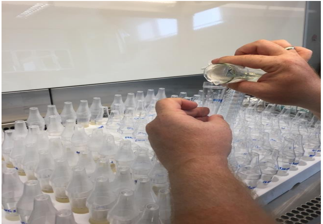
Şekil 3.5 Besin ortamlarının tüplere 10 mL olarak dağıtılmasının görünümü
