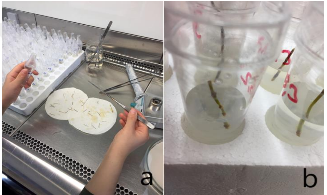
Şekil 3.6 Aseptik koşullarda H. germanicopolitanum bitkisinin dikimi a) Laminar flow kabin içerisinde yapraklarından arındırılmış eksplantların tüplere dikimi b) Dikim yapılmış eksplantların görünümü
