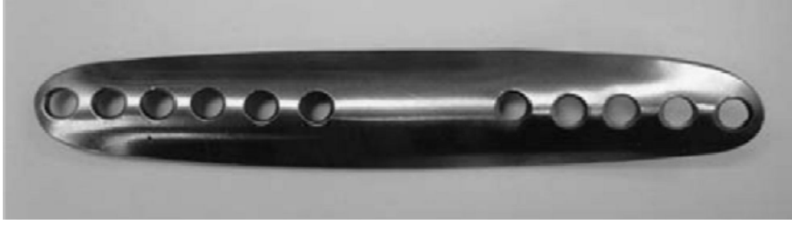
Şekil 2. İnce ve yuvarlak hatlara sahip Lambotte'nin plağı (1909 ) (1).
