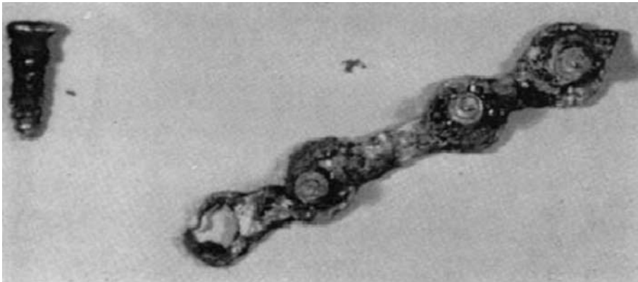
Şekil 1. Korozyondan dolayı kullanımdan kaldırılan Lane'in plağı (1895 ) (1).
