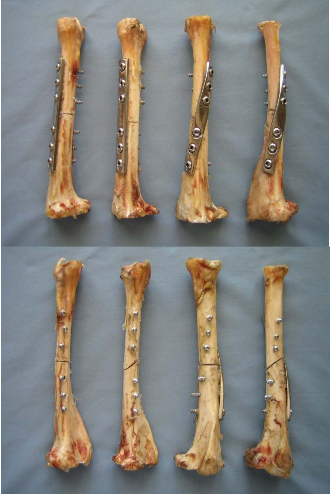
Şekil 20. Osteotomi sonrası plakların kemiklere tespit edilmiş görüntüleri.
