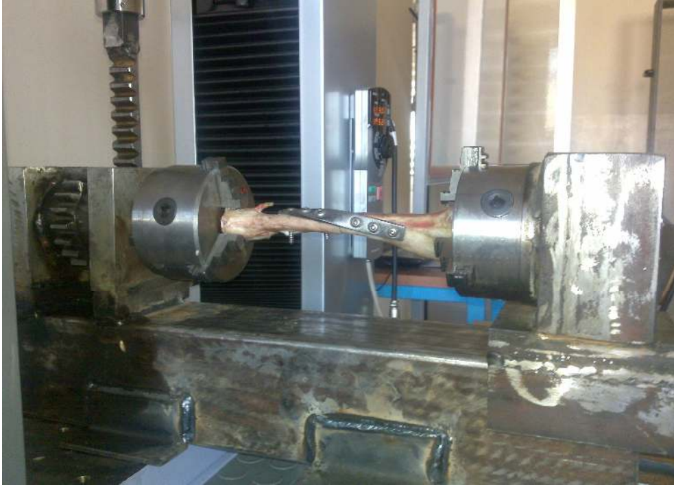
Şekil 28. Helikal plak tespiti uygulanan bir örneğin torsiyon testi.
