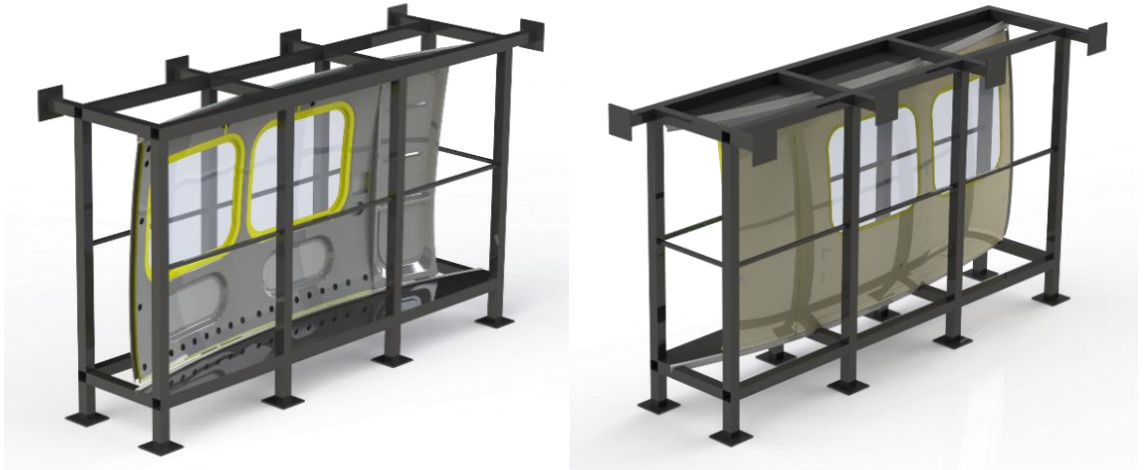
Şekil 3.2. Test platformunun nihai tasarımı
