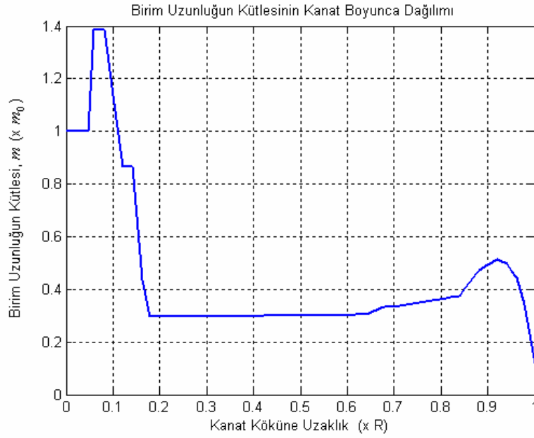
Şekil 1.1. Birim uzunluğun kütlesinin kanat boyunca dağılımı [37]
