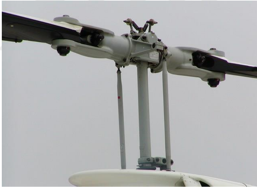
Şekil 2.8 Bell Jet Ranger helikopterine yunuslama ve aşağı-yukarı hareketini sağlayan yarı rijit rotor sistemi (İnt. Kyn.12).
