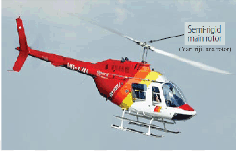
Şekil 2.7 Yarı rijit rotor sistemine sahip Bell Jet Ranger helikopterinin ileri uçuşu (İnt. Kyn.11).
