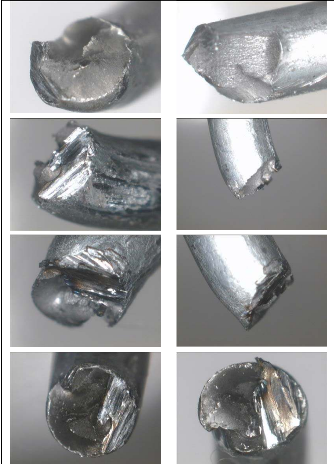
Resim 5.14. 2,36 mm apındaki elik tellerin arpma kesmesi deneyinde elde edilen kesme yzeyi fotoğrafları [52]
