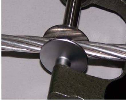
Resim 5.1. Kabloların ap lmn nasıl yapıldıėını gsterir fotoğraf [52]
