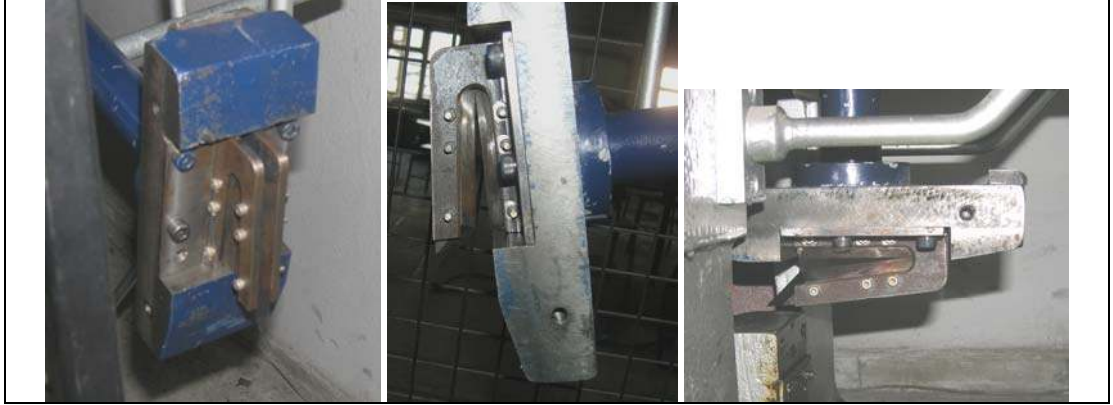
Resim 5.9. Charpy test cihazının ağırlıkları ve kırıcı çekici çıkartılarak kesici takım takılmış durumu [52]
