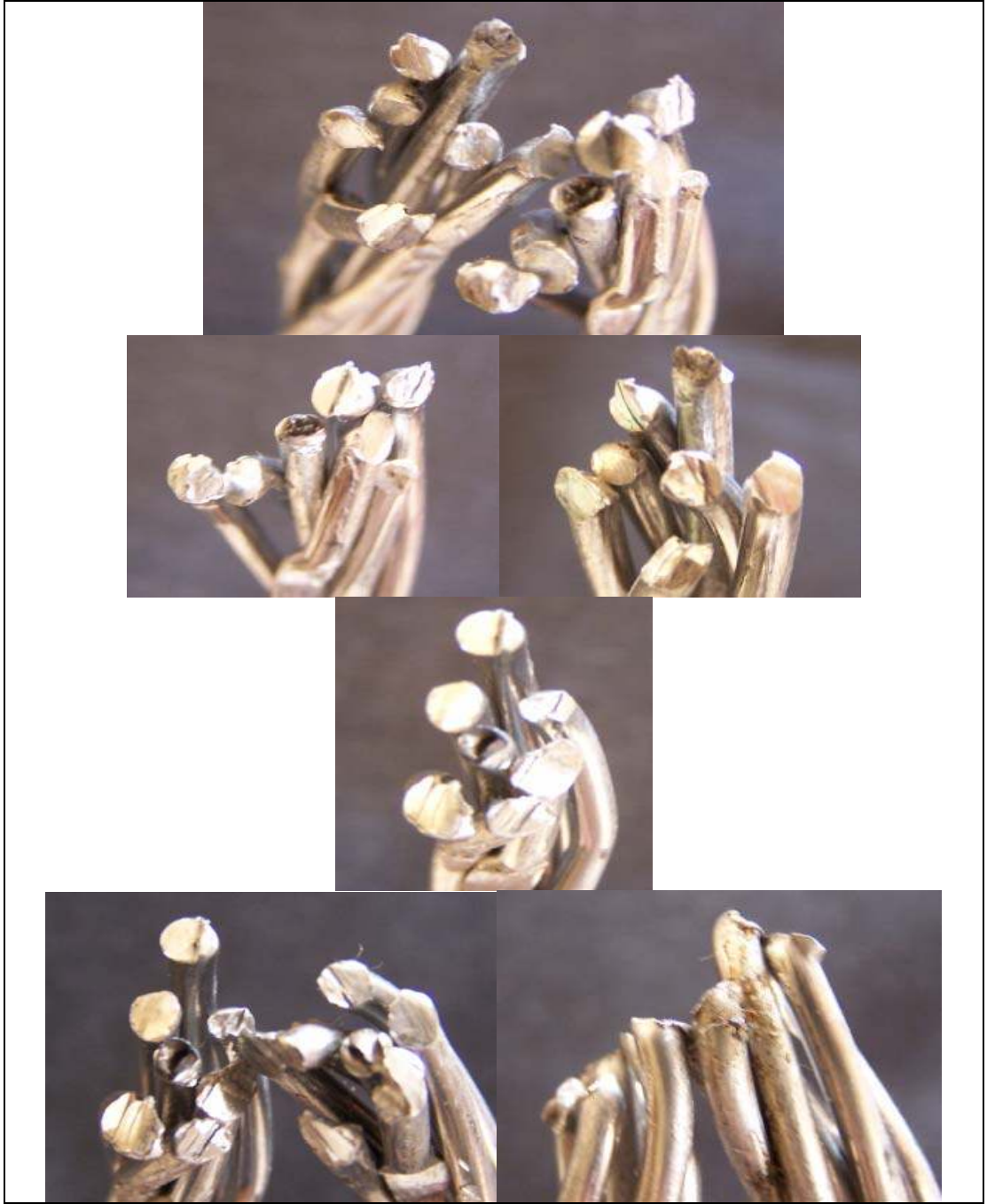
Resim 5.19. 6 Alüminyum ve 1 Çelik telli ve 7,18 mm dış çaplı kablonun kendisinin çarpma kesme deneyinde elde edilen kesme yüzeyi fotoğrafları [52]
