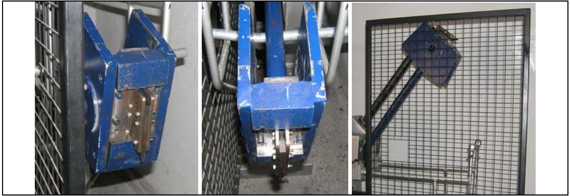
Resim 5.10. Charpy test cihazının, kesici takım takılmış ve ağırlıklarının ters takılmış durumu [52]
