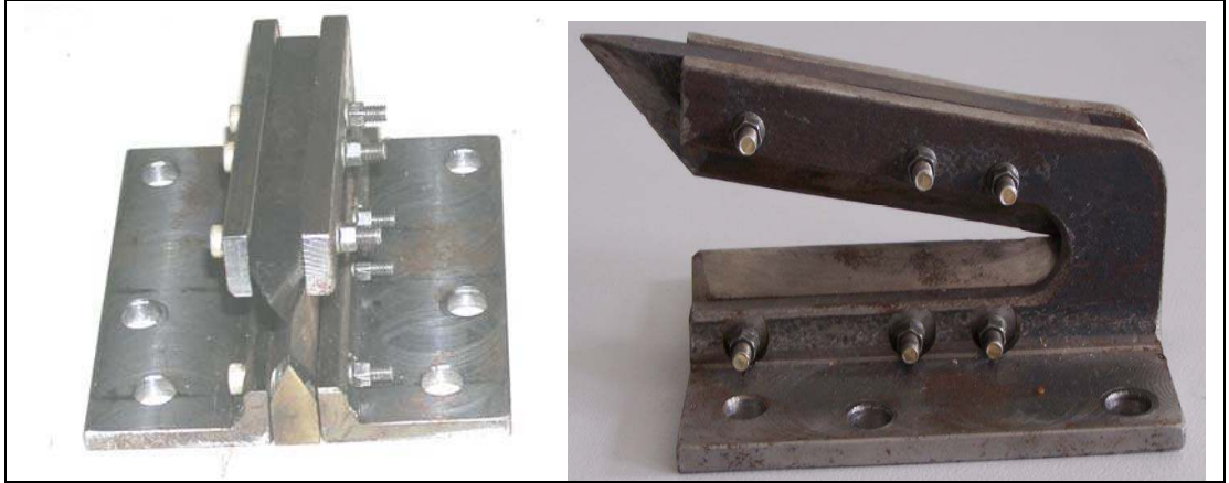
Resim 5.7. Charpy ve Isod test cihazının, kırıcı çekici yerine takılması için imal edilen kesici takım [52]
