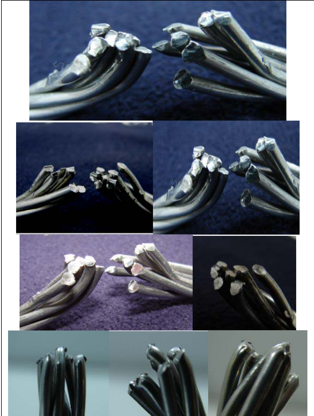
Resim 5.16. 7 Alüminyum telli 5,94 mm dış çaplı kablonun kendisinin çarpma kesme deneyinde elde edilen kesme yüzeyi fotoğrafları [52]
