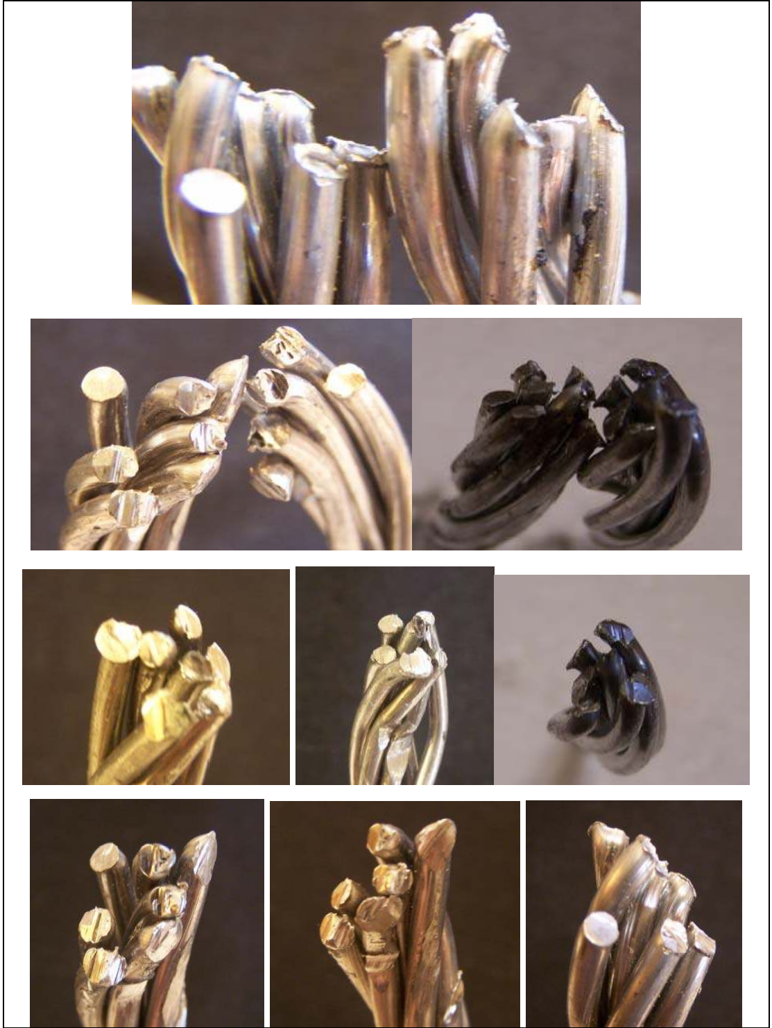
Resim 5.18. 7 Alüminyum-2 kalın telli 10,40 mm dış çaplı kablunun kendisinin çarpma kesme deneyinde elde edilen kesme yüzeyi fotoğrafları [52]
