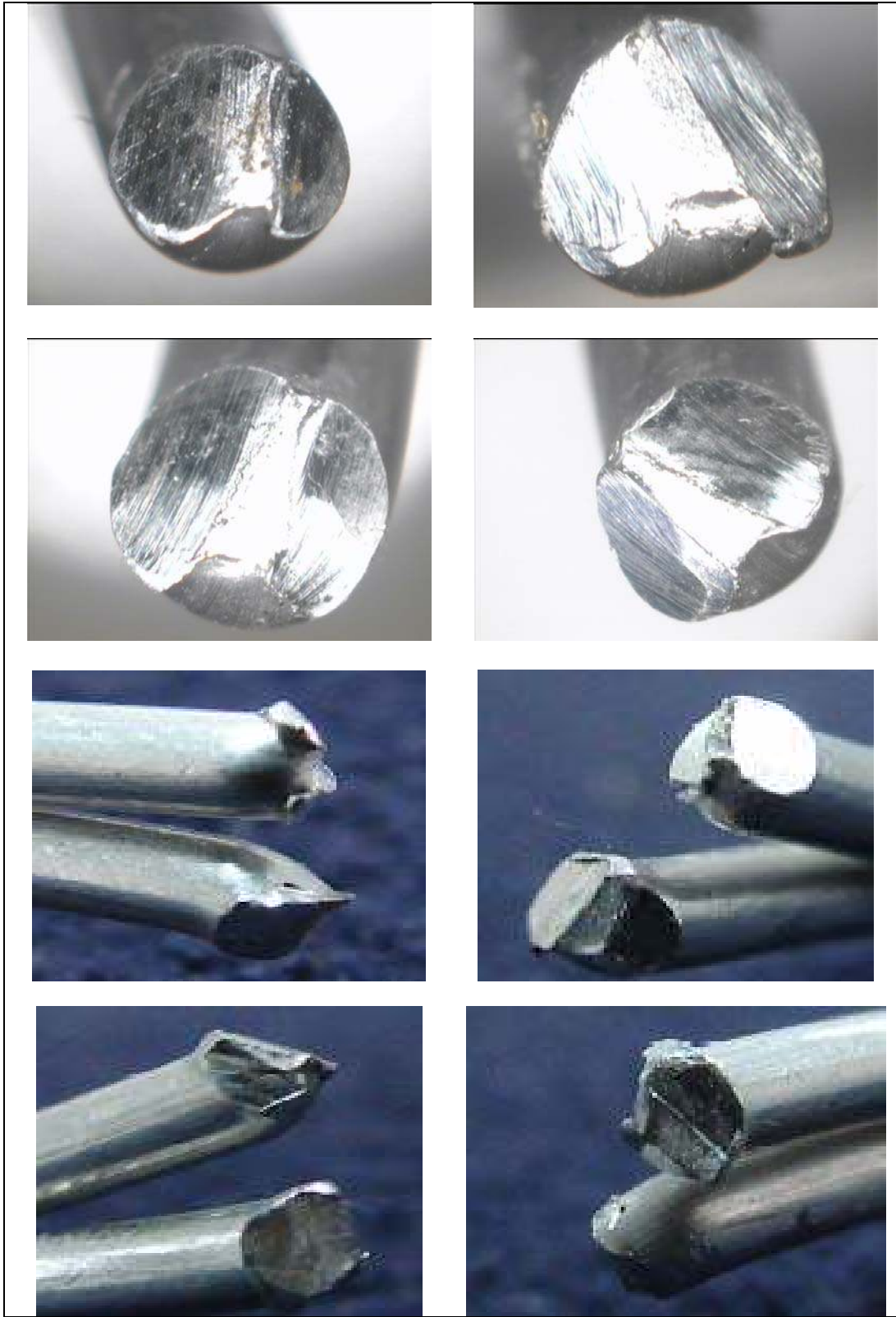
Resim 5.15. 3,5 ve 2,39 mm apındaki tek kat Alminyum tellerin arpma kesmesi deneyinde elde edilen kesme yzeyi fotoėrafları [52]
