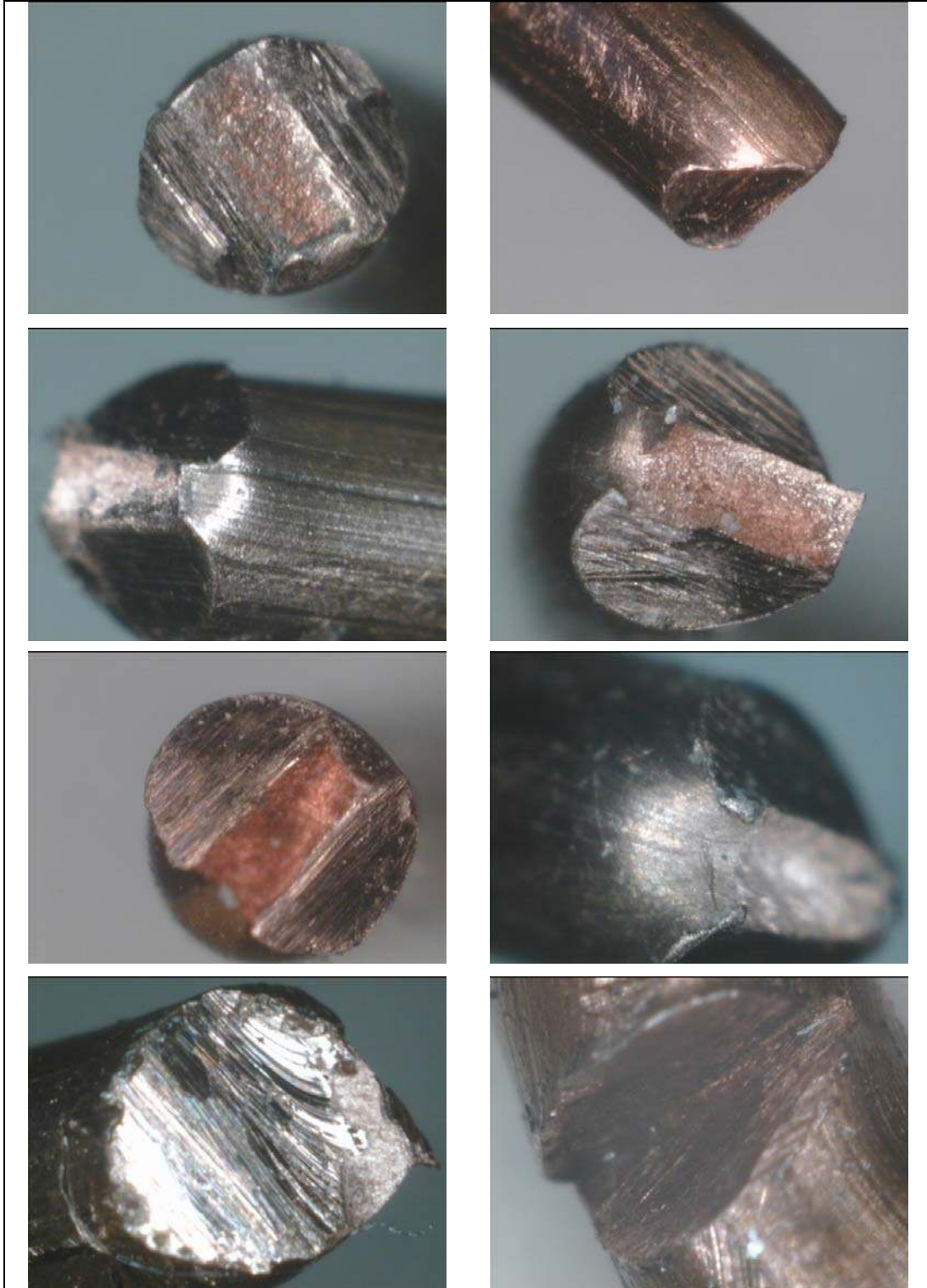
Resim 5.13. 1,31 mm apındaki Bakır tellerin arpma kesmesi deneyinde elde edilen kesme yzeyi fotorafları [52]
