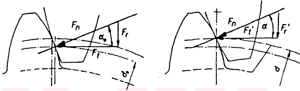
Şekil 1.8 Düz dişlinin etkisi altında bulunduğu kuvvetler [35-36]
