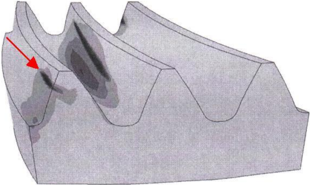
Şekil 2.29. Dişlerde ortaya çıkan büyük gerilmeler [18]
